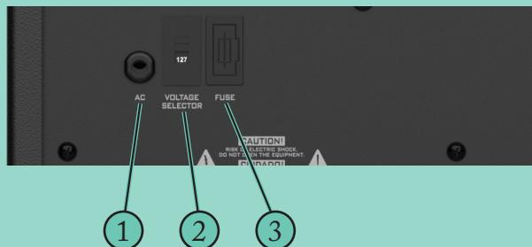
**1 - ENTRADA AC:** Entrada de energia elétrica de 127 V AC ou 220 V AC.
